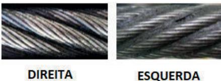
Determinar qual o lado de rotação do cabo direita ou esquerda.
